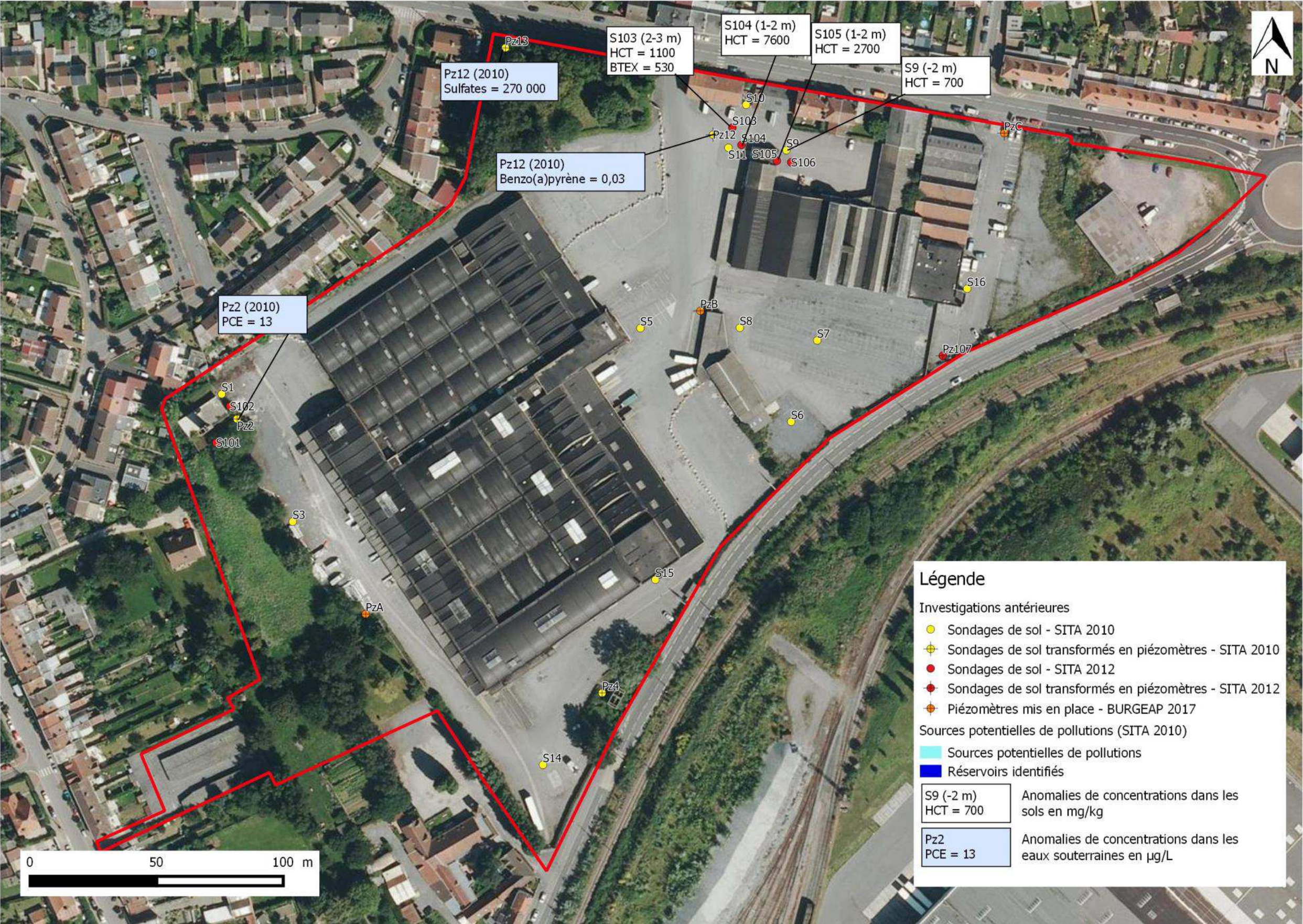
Figure 5 : Localisation des investigations antérieures et des impacts mis en évidence dans les sols et les eaux souterraines – Vue d'ensemble du site
