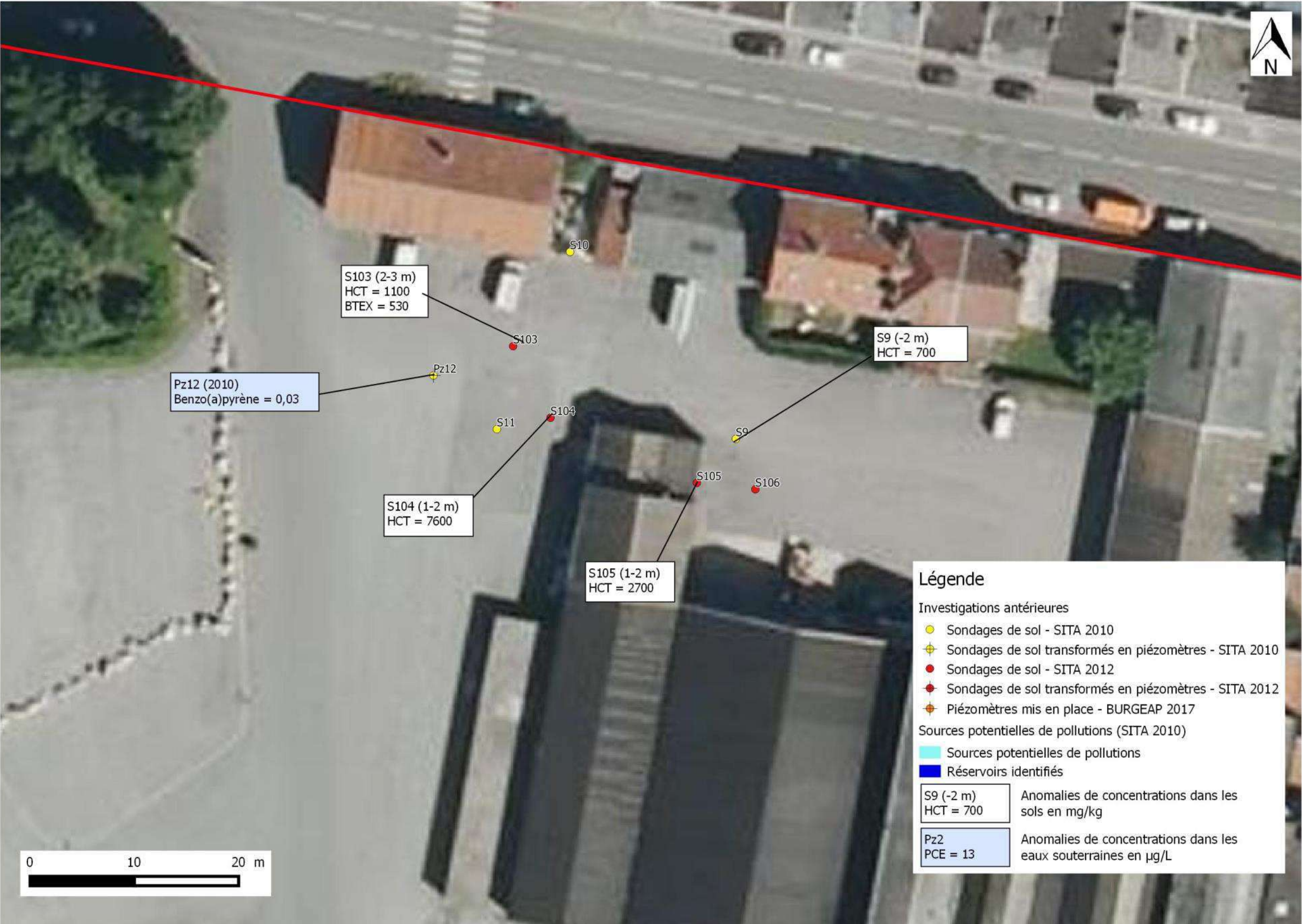
Figure 6 : Localisation des investigations antérieures et des impacts mis en évidence dans les sols et les eaux souterraines – zoom sur la zone des cuves R6 et R7
