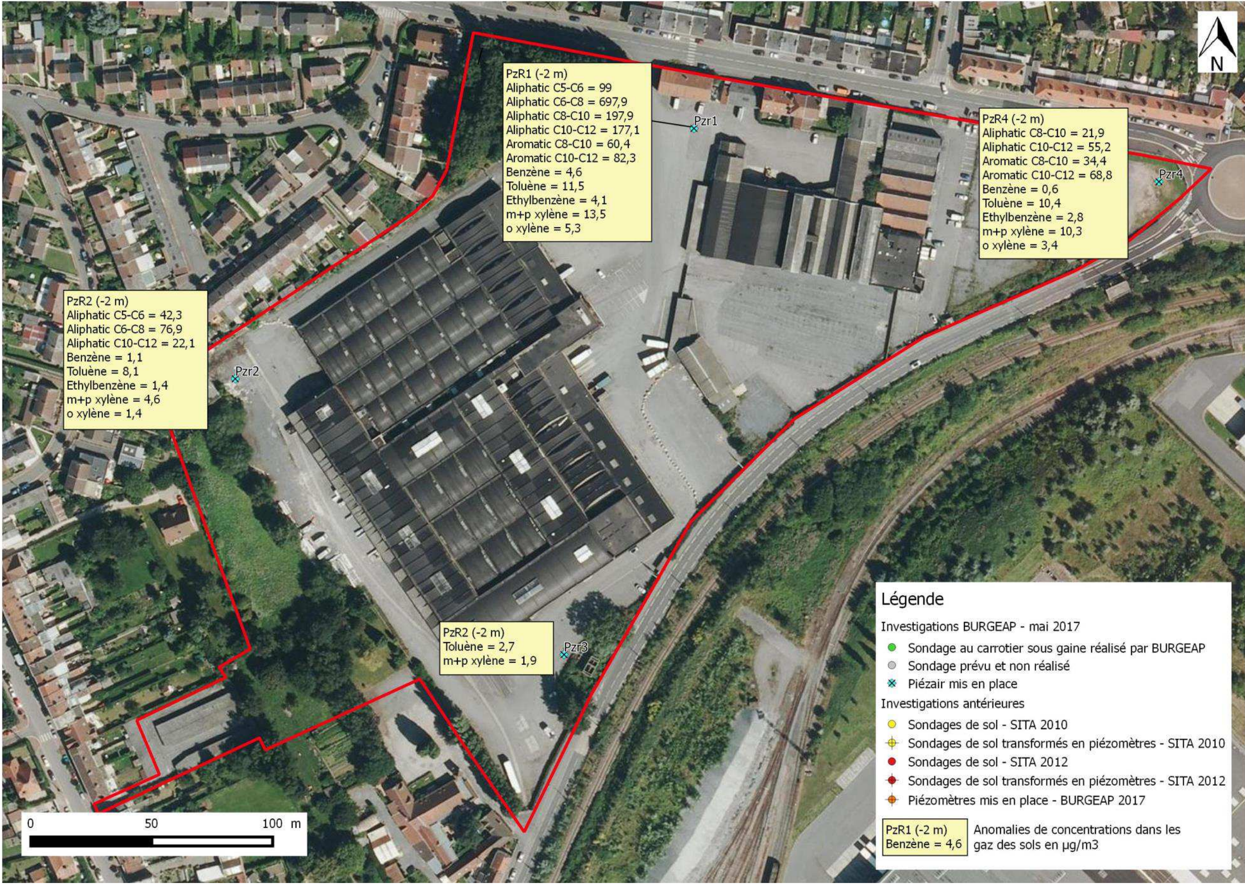
Figure 13 : Localisation des piézairs et synthèse des impacts dans les gaz des sols
