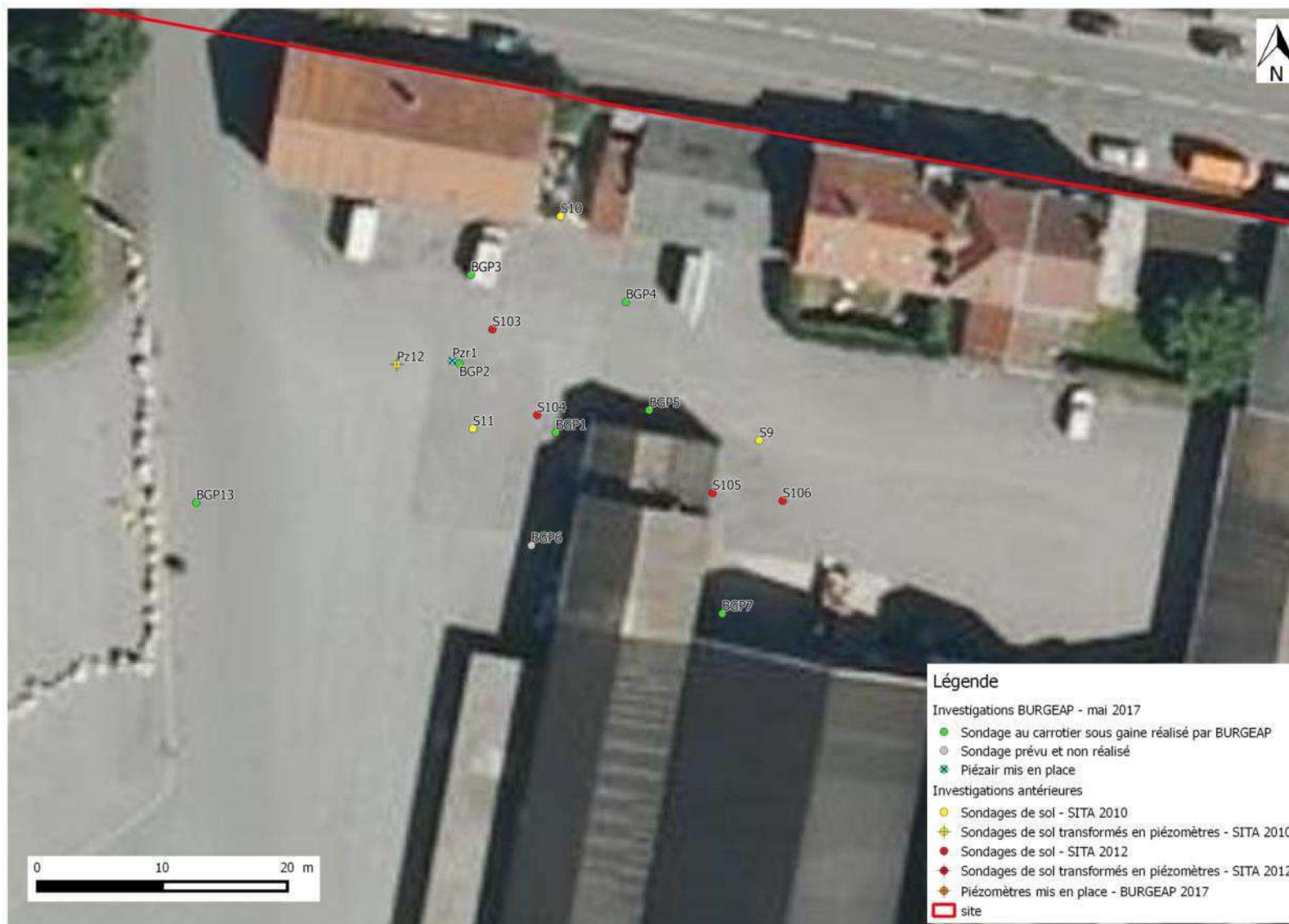
Figure 8 : Localisation des investigations complémentaires réalisées par BURGEAP en 2017 – Zoom sur la zone des cuves R6 et R7
